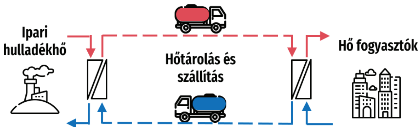
2. ábra. A mobil tárolós hőellátás felépítése
